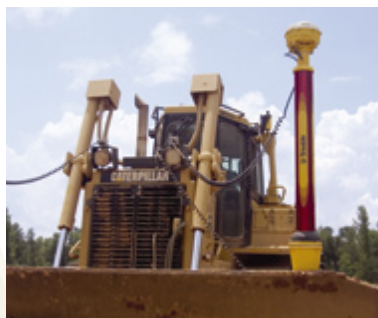
Control de pendiente 3D con láser para datos de elevación de alta precisión
