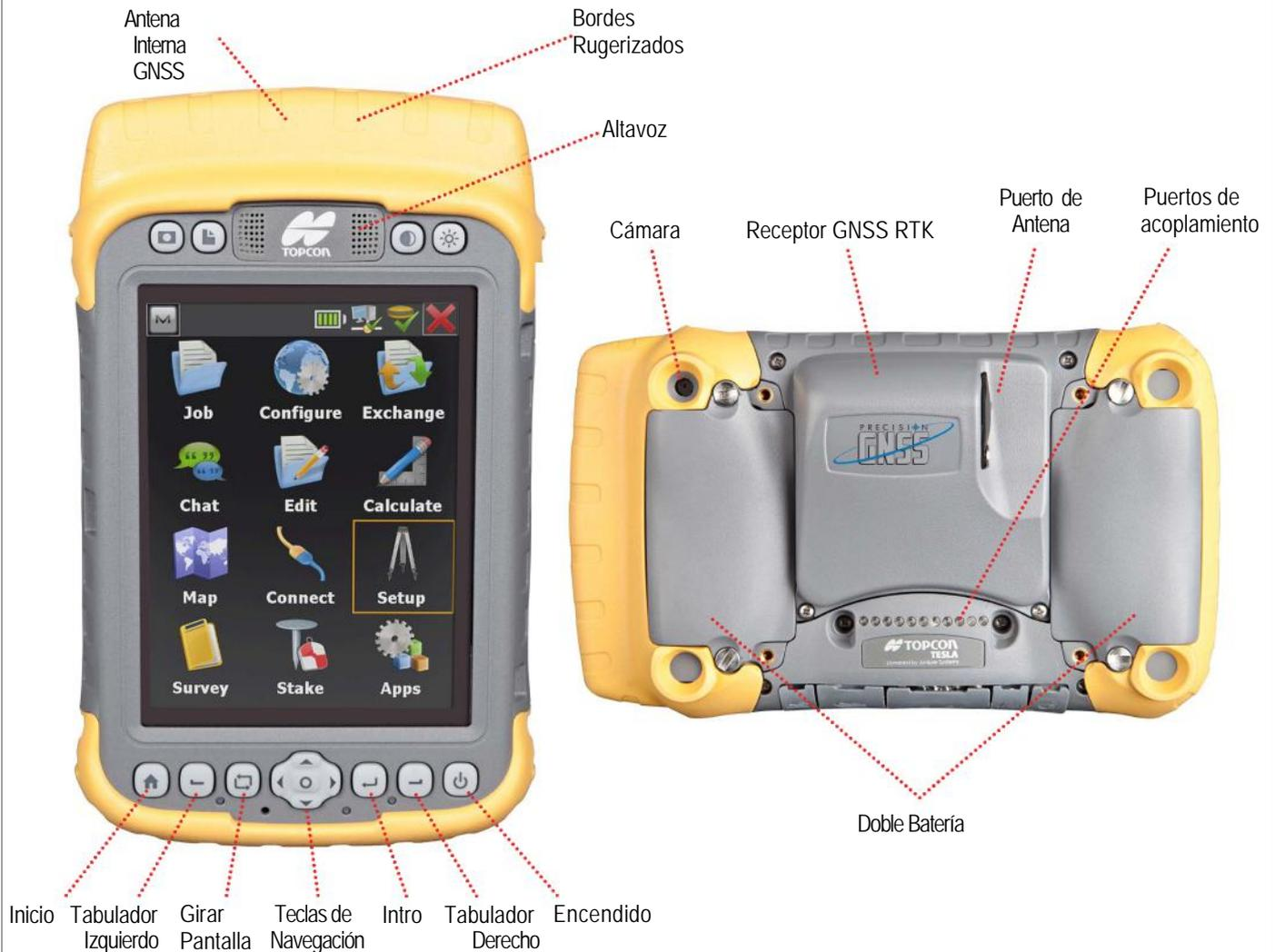
**Ruggedizado y a prueba de agua** La Tesla RTK es clasificada con IP67, lo que significa que puede ser sumergida en el agua y seguir funcionando. La unidad también puede soportar caídas desde 1,2 m y todavía funcionar. La fiabilidad de éste dispositivo en el campo es insuperable.
